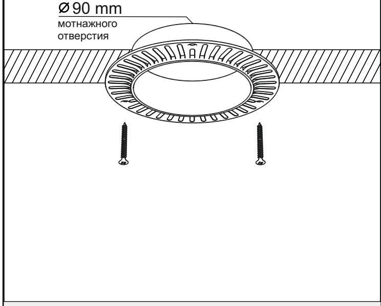
**ВАЖНО:** Установка светильника должна производиться при обесточенной электросети.
